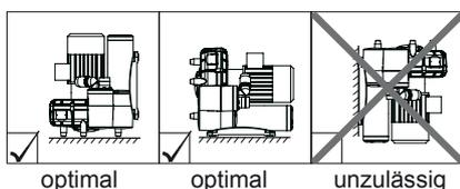
Die Abstände zu benachbarten Wänden sollten im freien Raum mindestens 10 cm betragen, damit die Luftströmung für die Kühlung nicht behindert wird. Beim Einbau in Schallschluckhauben fragen Sie in unserem Werk nach.
