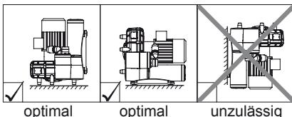
Die Abstände zu benachbarten Wänden sollten im freien Raum mindestens 10 cm betragen, damit die Luftströmung für die Kühlung nicht behindert wird. Beim Einbau in Schallschluchthauben fragen Sie in unserem Werk nach.
