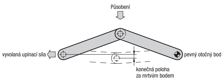
U upínačů, které působí na přímce, je použito působení kolenového pákového systému, aby bylo možno provádět operace jako např. děrování, vrtání, tvarování, lepení, spárování, nýtování, svařování a spojování.
