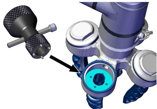
4. Den Greiffinger aus der Halterung entfernen.
