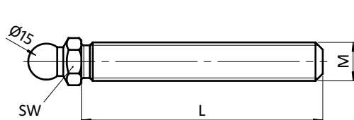
Gewindestange Stahl für Gelenkstellfüße, Kugel 15 Threaded Rod for Swivel Feet, Ball Joint 15
