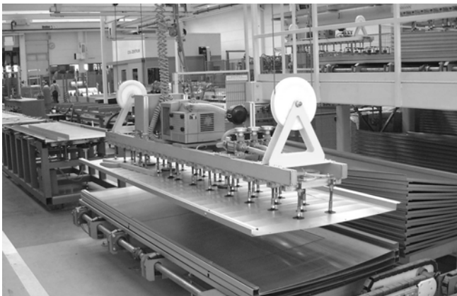
Elektromagnetventile EMV zur segmentweisen Vakuumsteuerung in der Saugtraverse
