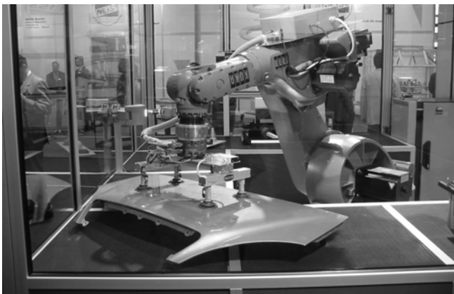
Dezentrale Steuerung der Sauggreifer einer Saugerspinne über Inlineventile
