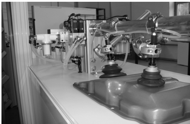
Montagebeispiel HTR-FST A3 an Saugerspinne
