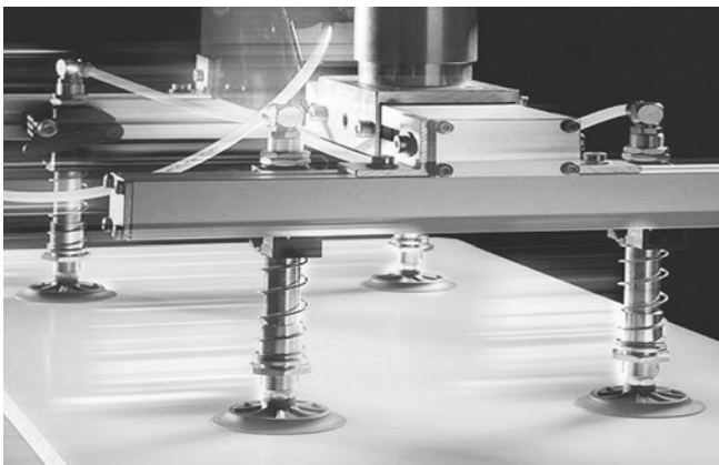
Saugerspinne mit Federstößeln FSTF für die Handhabung beschichteter Holzplatten
