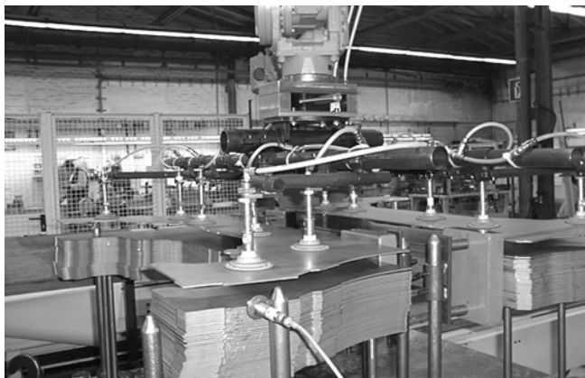
Federstößel FSTE-HD an Saugerspinne zur Blechhandhabung in der Automobilindustrie
