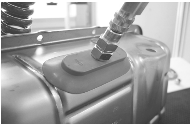
Glockensauggreifer SAOG zum Heben von stark geformten Blechteilen
