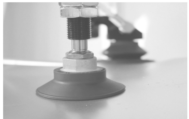
Flachsauggreifer SAF montiert auf Saugerspinne zum Heben von Blechformteilen
