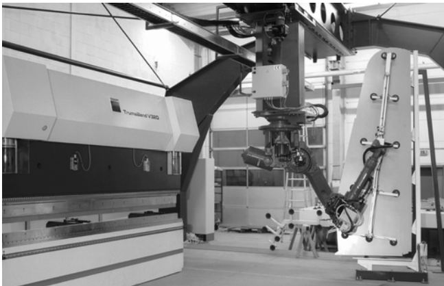
Saugerspinne mit Flachsauggreifern SAF zur automatischen Beladung einer Abkantmaschine mit Blechen
