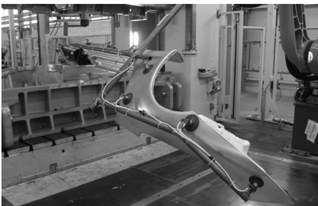
Saugerspinne mit Flachsauggreifern SAF für das Handling von Karosserieteilen in der Automobilindustrie
