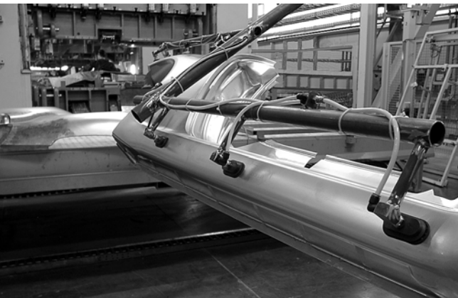
Saugerspinne mit Balgsauggreifern SAOB für das Handling von Karosserieteilen in der Automobilindustrie
