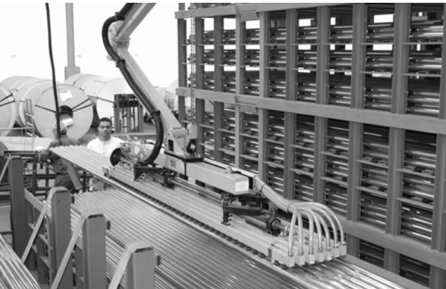
Handhabung von Rohren mit anpassungsfähigen Balgsauggreifern FSG und FSGB
