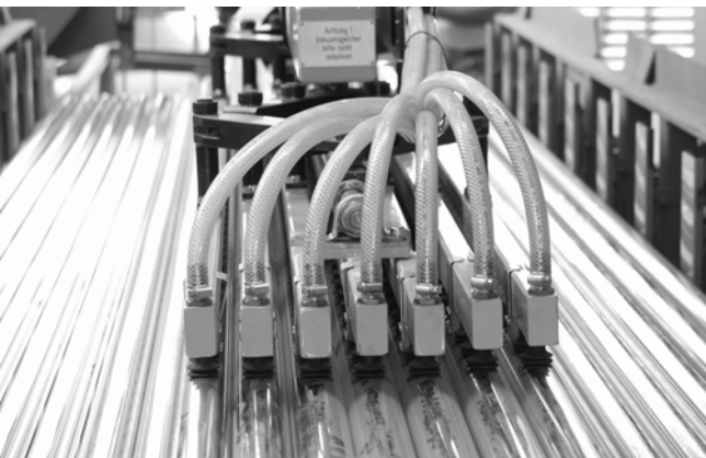
Handhabung von Rohren mit anpassungsfähigen Balgsauggreifern FSG
