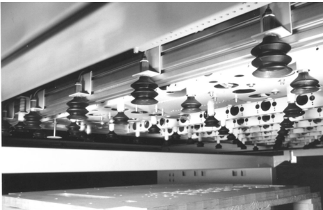
Verschleißfeste Balgsauggreifer FSG VU1 zur Blechhandhabung
