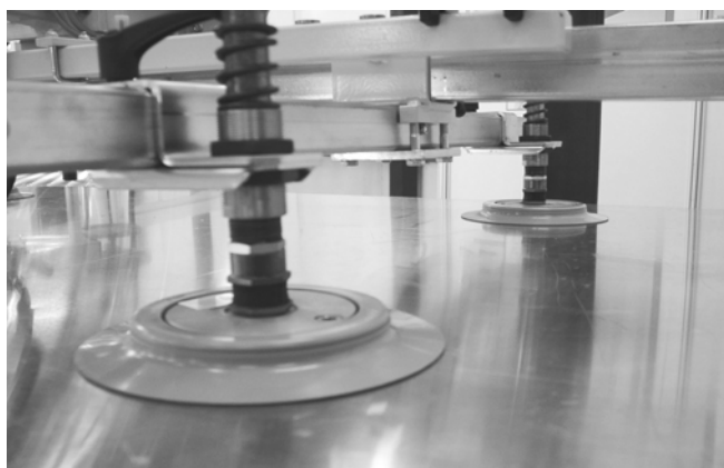
Saugplatte SPU montiert an manuell geführtem Vakuum-Hebegerät
