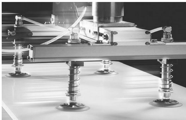
Vakuumgreifer ausgerüstet mit Flachsauggreifern SHFN zur Handhabung von Holzplatten
