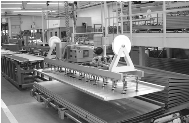
Anlage mit verschleißfesten Sauggreifern PFYN-VU1 zur Handhabung von großen Blechteilen
