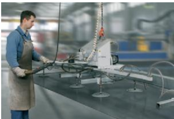
VacuMaster Vario, 1.000 kg Traglast, horizontal zur Be- und Entladung von Plasma-schneideanlagen
