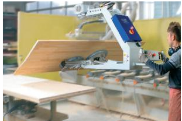
VacuMaster Comfort, 125 kg Traglast, 180° Wenden zur Beladung von CNC-Maschinen mit Leimholzplatten
