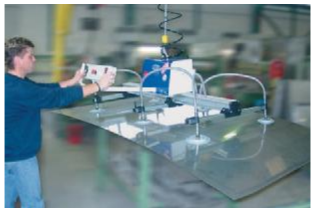
VacuMaster Comfort, 250 kg Traglast, horizontal zur Be- und Entladung von Blech-bearbeitungsmaschinen
