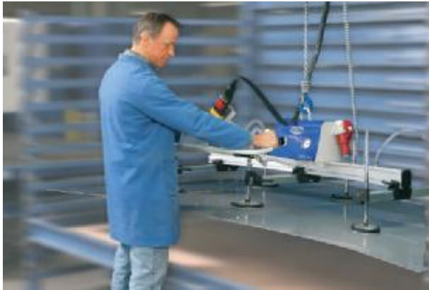
VacuMaster Basic, 250 kg Traglast, horizontal zur Be- und Entladung von Blechregal-systemen
