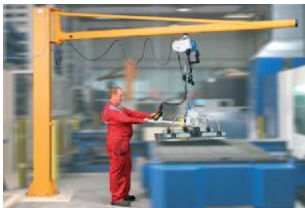
VacuMaster Basic, 250 kg Traglast, horizontal zur Handhabung von Edelstahlblechen
