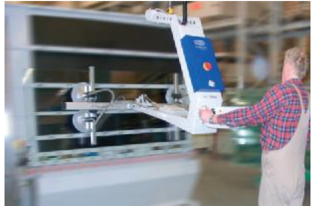
VacuMaster Comfort, 125 kg Traglast, 180° Wenden zur Be- und Entladung von Glasreinigungsanlagen
