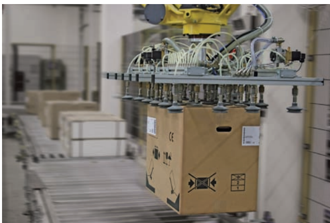
Kundenspezifische Ausführung Vakuum-Saugspinne SSP zur Handhabung von unterschiedlich großen Kartonagen
