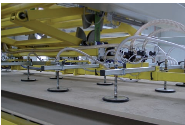
Kundenspezifische Ausführung der Vakuum-Saugspinne SSP mit Saugplatten
