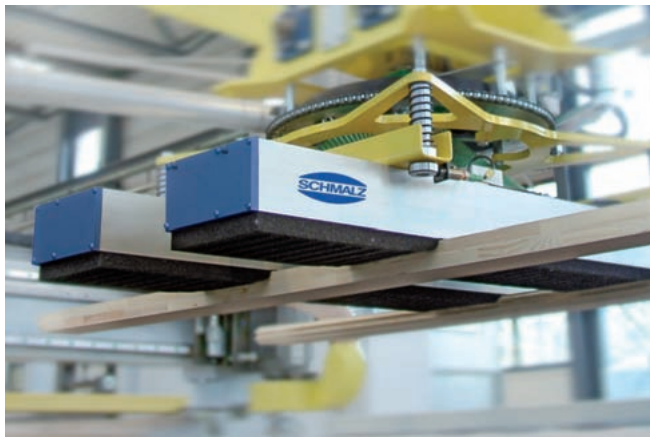
Vakuum-Flächengreifsystem SBX zur Handhabung von Holzbrettern
